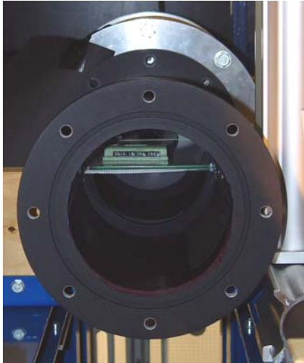
Abbildung 5.7: Justierung der Kalibrierplatte
