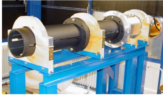
Abbildung 3.3: Experimenteller Aufbau des Drallbrennermodells
