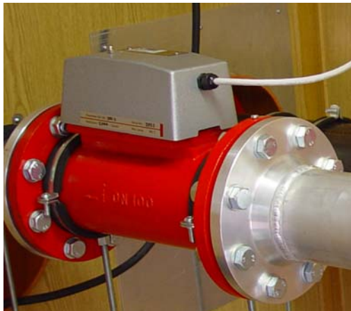
Abbildung 3.16: Oszillations-Durchflussmesser/-zähler vom Typ DOG-1/3 der Firma Kobold Messring GmbH
