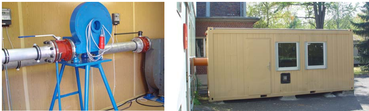
Abbildung 3.15: Radialgebläse (links), Messcontainer (rechts)
