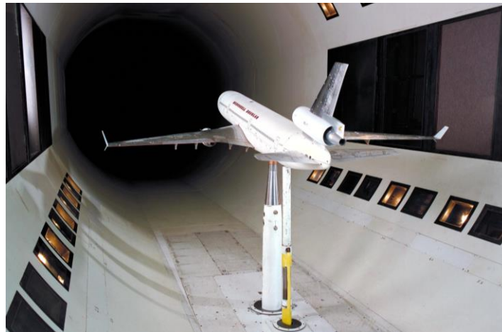
Abbildung 2-4: Geometrisch skaliertes Prototyp eines Flugzeugs in einem Windtunnel in entsprechender Größe 76
