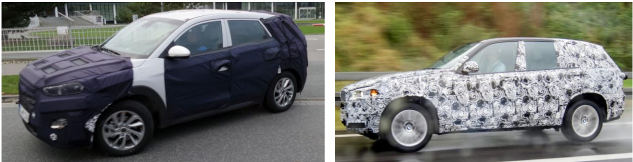
Abbildung 6-3: Tarnung von Fahrzeugen im Straßentest mittels geometriekaschierenden Anbauteilen (links 250 ) und mit speziell gemusterter Folie (rechts 251 )
