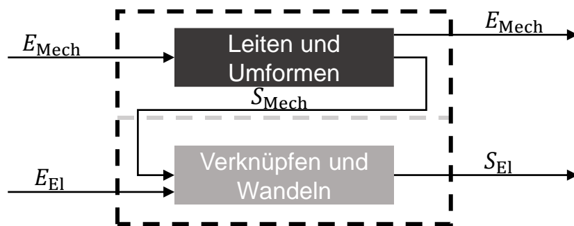
Abbildung 4-2: Verallgemeinerter Zusammenhang der Teilfunktionen sensor-integrierender Maschinenelemente 167
