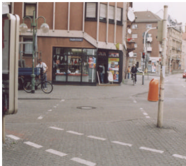
Bild 6: Fußgängersignalgeber über die Jungbuschstraße mit weit abgerücktem Signalgeber
