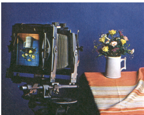
Abb. 6 Abbildung eines Gegenstandes auf der Belichtungsebene einer Kamera, aus: [ROC-85]
