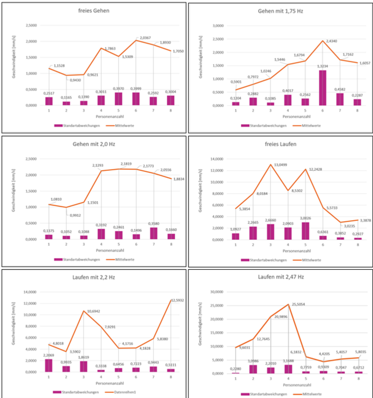
Abbildung 5.45.: Normierte Schwinggeschwindigkeit in Feldmitte bei Anregung durch unterschiedlich große Personengruppen
