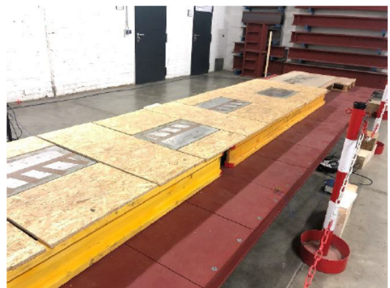
(b) Aufbau der Plattform zur Sicherung der Probanden bei langen Schrittweiten
