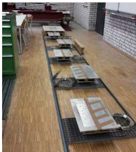
Abbildung 5.8.: Anordnung der Kraftmessplatten zu einem Laufsteg
