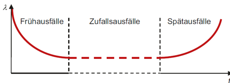
Abbildung 7: Typischer Verlauf der Ausfallrate \lambda über die Zeit t , Bildquelle: Lienig & Brümmer (2024, S. 55).
