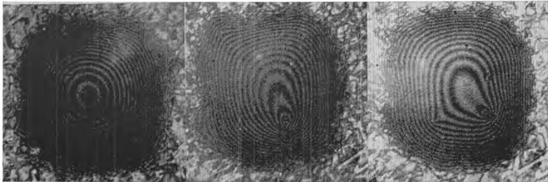
Bild 5.1 Interferenzaufnahmen eines Farbpunktes (Offset-Farbe) bei drei verschiedenen Geschwindigkeiten. Die Höhendifferenz zweier benachbarter Interferenzlinien beträgt 0,25 \mu\text{m} .
