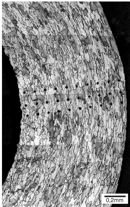
Abbildung 4.17: Schliff einer 180°-Biegeprobe mit Härteeindrücken in der Mitte des Biegeradius.
