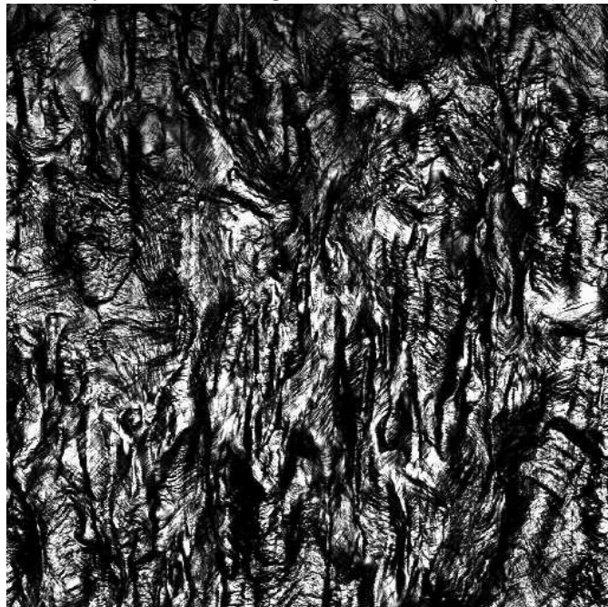
Abbildung 4.3: Topographie des Blechs 1 unmittelbar oberhalb des Risses (500 \mu\text{m} Kantenlänge).
