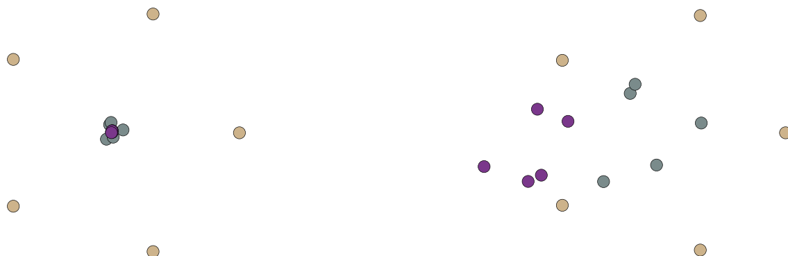
Abbildung 2.22: Illustration von Lemma 2.41. Eine Startkonfiguration von fünf Kontrollpunkten (gelb) wird mit einer Matrix verfeinert, die die Qualitätskriterien Q1 und Q3 erfüllt (links) und mit einer Matrix verfeinert, für die die Qualitätskriterien Q1 und Q3 nicht gelten (rechts). Für die Verfeinerung nach zwei Schritten (grau) und die Verfeinerung nach vier Schritten (lila) lässt sich erkennen, dass links die neuen Punkte konvergieren, wohingegen rechts die neuen Kontrollpunkte willkürlich im Raum angeordnet sind.
