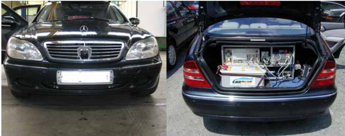
Abbildung 5-15: Versuchsfahrzeug mit integrierter Messtechnik
