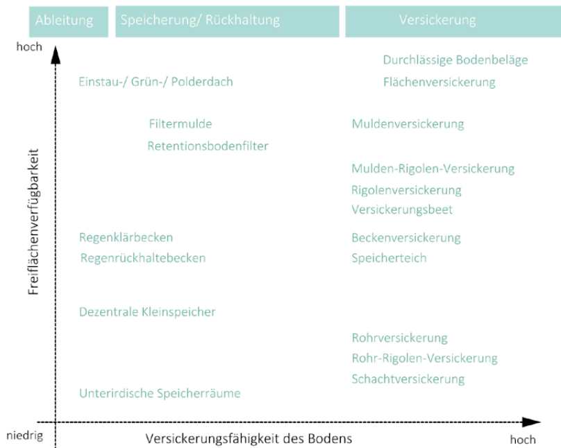
Abb. 6. Verhältnis Flächenverfügbarkeit und Versickerungsfähigkeit (Eigene Darstellung nach Geiger et al. 2009, Londong 1994)
