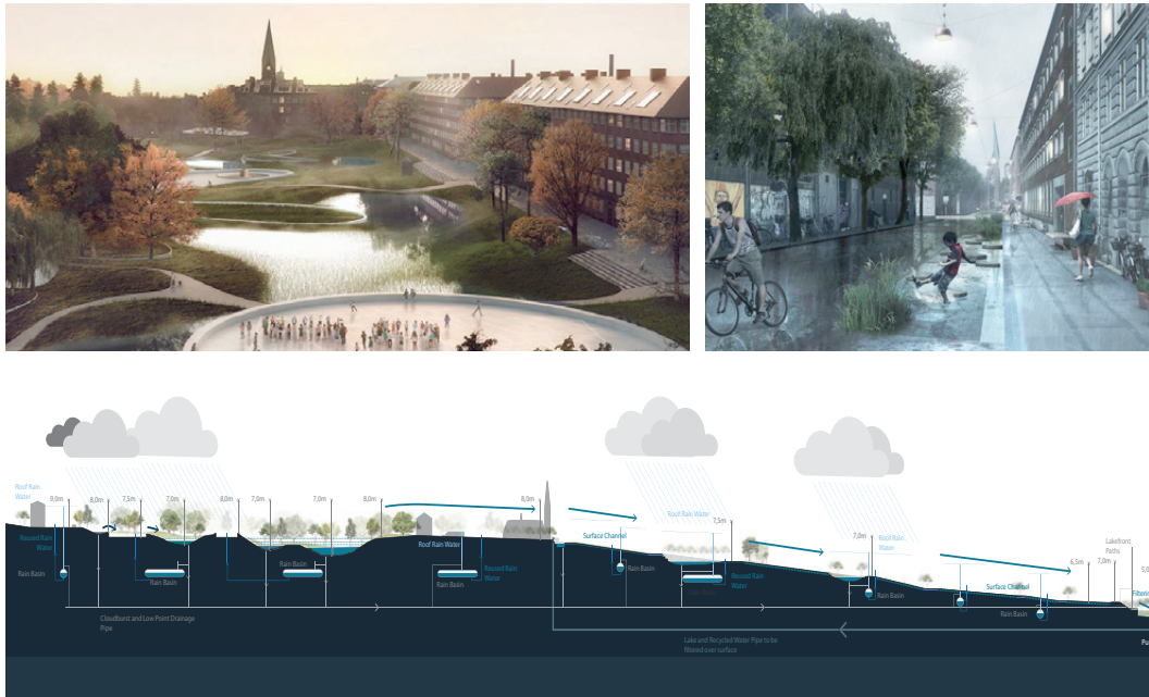
Abb. 45. Visualisierung und Schnitt Regenwassermanagement Hans Tavens Park, Quelle: SLA Landschaftsarchitekten
