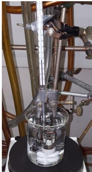
**Abbildung 6.1:** Versuchsaufbau zur Bestimmung der Gelierungstemperatur  $T_G$  eines Organogels.
