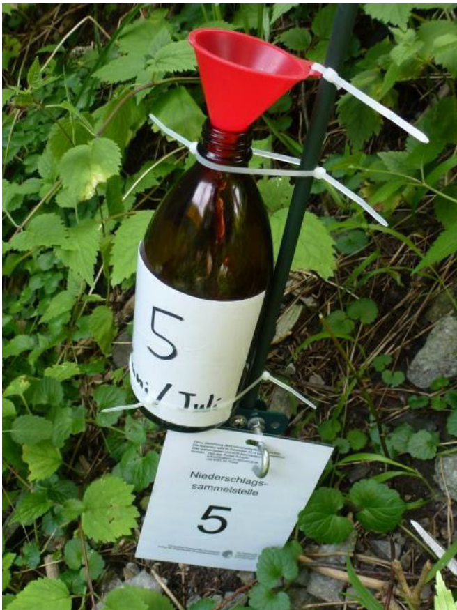
Abb. 5: Sammlung von Niederschlagsproben zur Analyse der Isotopenzusammensetzung im Labor.
