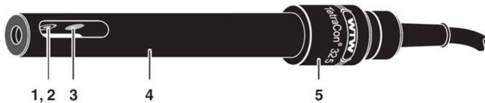
Abb. 14: Aufbau und Funktion einer Sonde zur Bestimmung der elektrischen Leitfähigkeit. 1: Spannungselektrode (innerer Ring), 2: Stromelektrode (äußerer Ring), 3: NTC-Thermistor, 4: Schaft und 5: Sondenabschluss; die Bauteile 1 und 2 sind auch auf der anderen Seite des Schlitzes vorhanden (WTW 2009a, S. 4).
