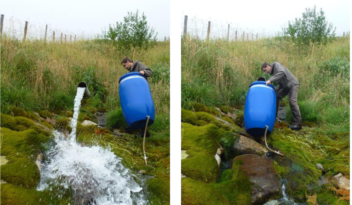
Abb. 7: Schüttungsmessung mit einer Tonne an den Hintertuxer Thermalquellen, Österreich. Hier wurde eine Schüttung von etwa 17 L/s ermittelt.
