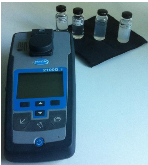
Abb. 28: Nephelometer der Firma HACH mit einigen Formazin-Standard suspensionen.
