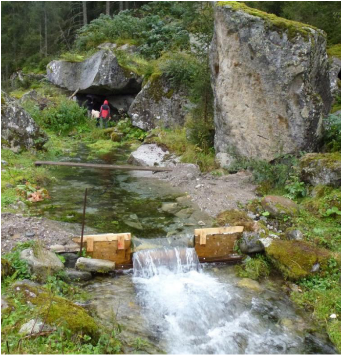
Abb. 11: Beispiel eines Messwehres an der Sulzenalmquelle im Floitengrund, Österreich (links) und Prinzipskizze zum Bau eines Messwehres (rechts, aus Coldewey & Göbel 2015, S. 44).
