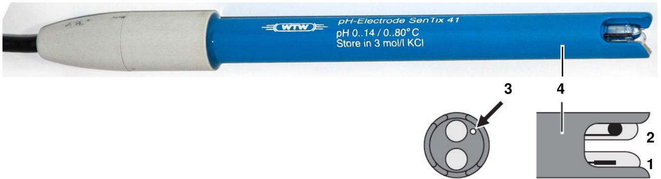
Abb. 15: Aufbau und Funktion einer Einstabmesskette zur Bestimmung des pH-Wertes. 1: Messelektrode (Glaselektrode), 2: Referenzelektrode (Bezugselektrode), 3: Diaphragma und 4: Schaft (verändert aus WTW 2010, S. 5).
