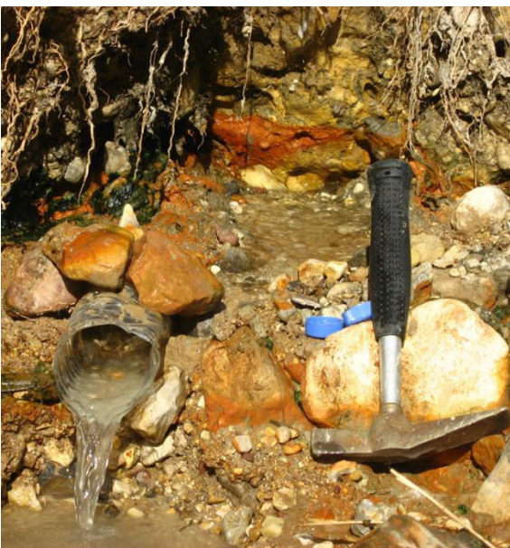
Abb. 8: Improvisation einer Messstelle mit Steinen, tonigem Boden und einer Plastikflasche (linkes Bild). Skizze eines Damms mit kanalisiertem Durchlauf zur Abflussmessung (rechtes Bild, Coldewey & Göbel 2015, S. 39).
