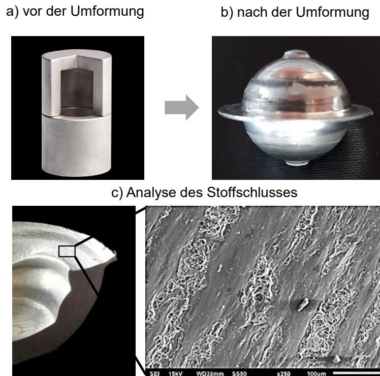
Abbildung 10-4 Herstellung einer Hohlkugel aus EN AW 6082 T6 vor a) und nach b) der Umformung sowie mikroskopische Analyse des Stoffschlusses eines Bauteils nach der Umformung c)
