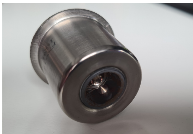
Abb. 2.8: Fotografie der in der Arbeit verwendeten Xe-Blitzlampe FX-1165 von Excelitas Technologies . Die Lampe besitzt ein \text{MgF}_2 -Fenster und kann damit Licht bis zu einer Energie von 10,3 eV in den Monochromator einkoppeln.
