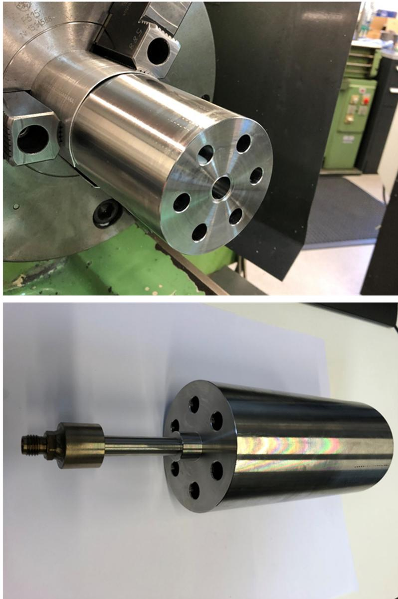
Abbildung 5.48: Reaktorblock aus Hochtemperaturstahl (1.4841). Zu erkennen sind die Bohrungen für die Quarzglaskapillare, den Millirohrkatalysator und die Heizelemente. Der angeschweißte vordere Flansch ist ebenfalls zu sehen.
