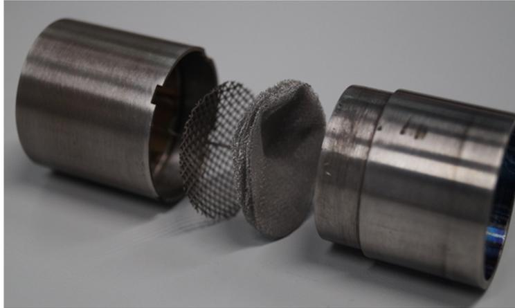
Abbildung 4.4: Hülse zur Fixierung des Katalysators im Reaktor. Gefertigt aus Hochtemperaturstahl (Stahlschlüssel 1.4841). Zu erkennen sind beide Hülsesteile sowie das Katalysatornetzpaket und ein Edelstahlstütznetz (Megapyr®).
