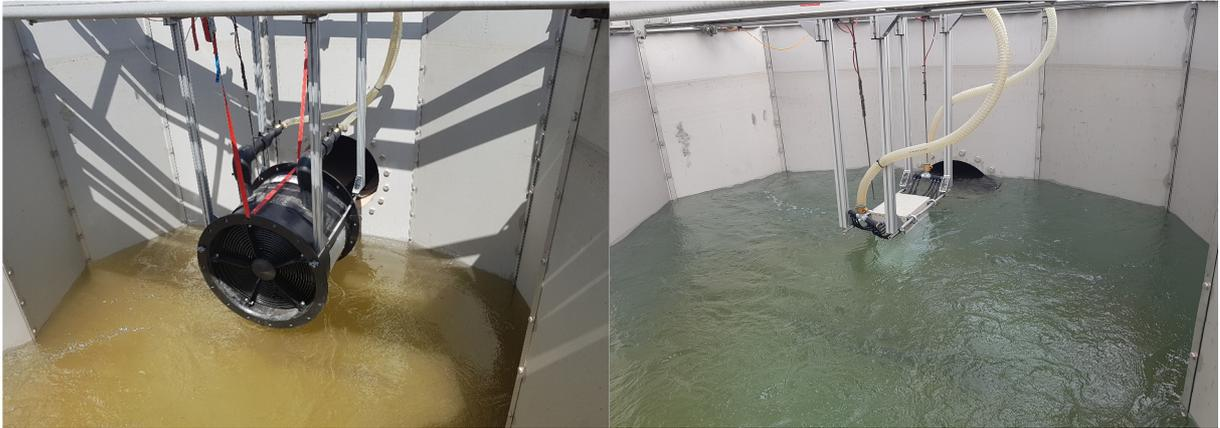
Abbildung 5-36: Ansicht entgegen der Strömungsrichtung auf die ausgerichteten Prüfmuster, die mittels Spiralschläuchen an den Wärmeträgerkreis angeschlossen sind, während das Wasserbecken befüllt wird.
