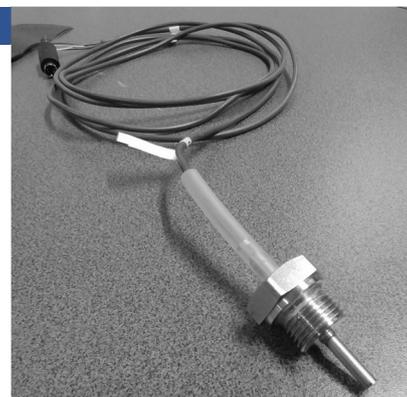
Anhang A-11: Leistungsmerkmale der thermoresistiven Temperaturmessung im Wärmeträgerkreis.
