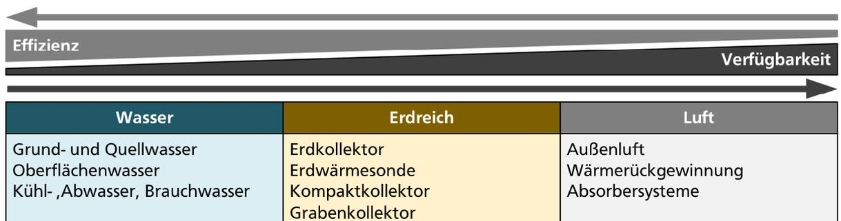
Abbildung 2-26: Verfügbarkeit und Effizienz der unterschiedlichen Wärmequellen nach Viessmann (2011, 38).
