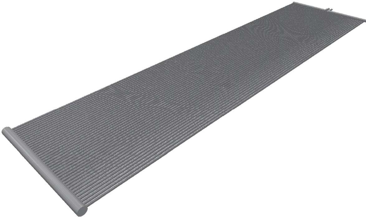
Anhang A-35: Schematische Darstellung des Rippenrohrumkehrabsorbers.
