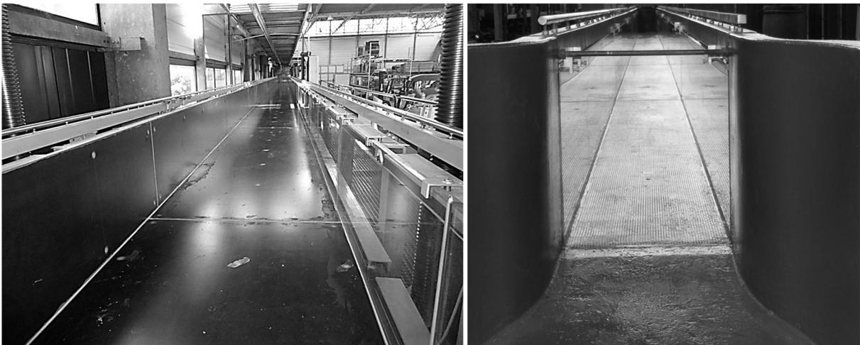
Abbildung 5-14: Langgestreckte Wasserkanäle mit rechteckigem Strömungsquerschnitt im wasserbaulichen Forschungslabor der Technischen Universität Darmstadt (Fachgebiet Wasserbau und Hydraulik, TU Darmstadt).
