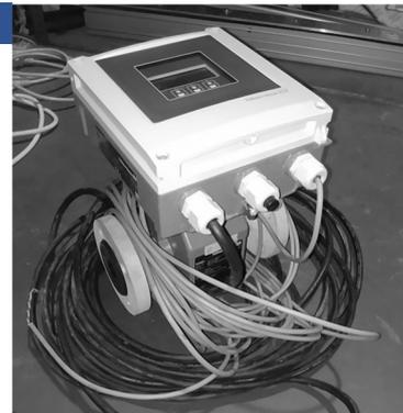
Anhang A-10: Leistungsmerkmale der magnetisch-induktiven Durchflussmessung.
