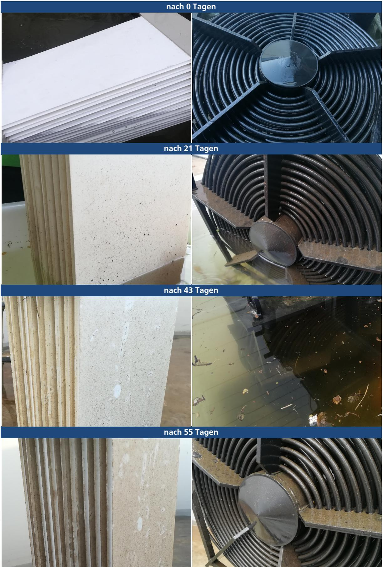
Abbildung 5-71: Zeitlicher Verlauf der Ablagerungen auf den wärmeübertragenden Flächen.
