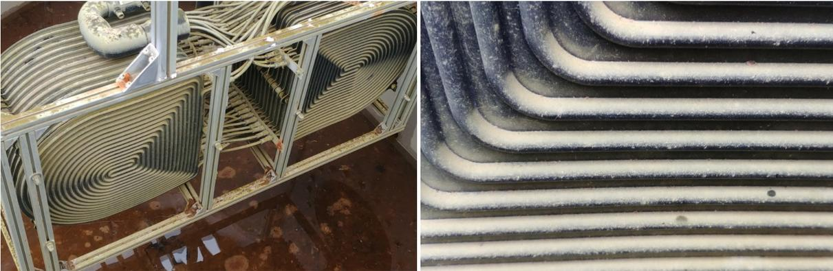
Abbildung 5-72: Langzeitstudie mit Prüfmuster im leeren Prüfstand (links) und Nahaufnahme der Ablagerungen auf den wärmeübertragenden Flächen nach 120 Tagen (rechts). Die Aufnahmen sind nach den Messungen zum äußeren Wärmeübergang entstanden.
