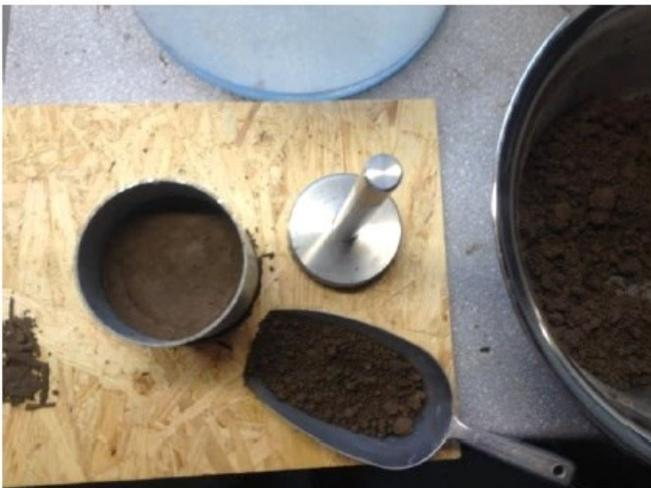
Abbildung 5-13: Vorbereitung von Mischproben zur Bestimmung der Lagerungsdichte
