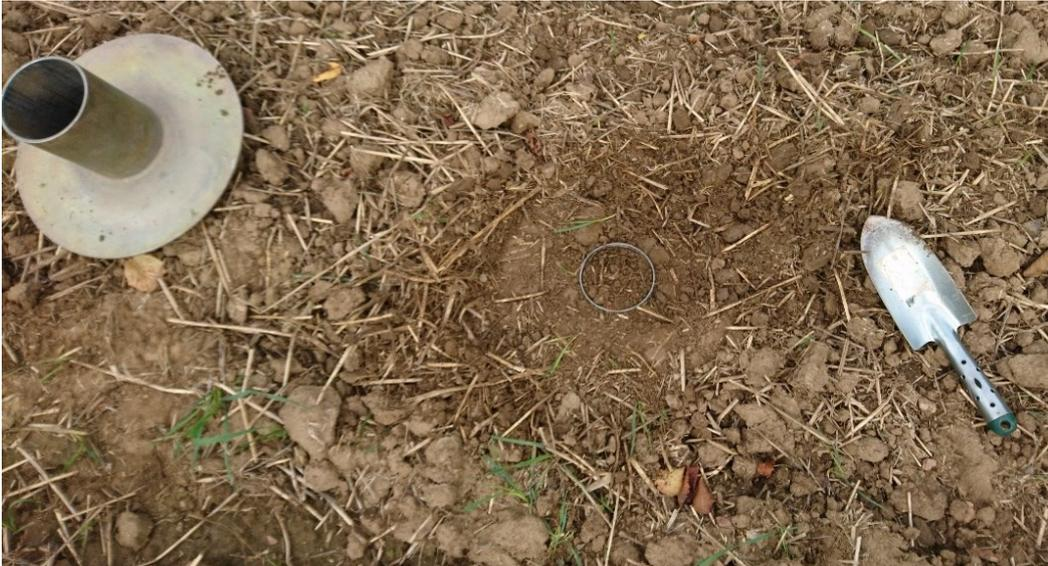
Abbildung 5-12: Entnahme einer Oberflächenprobe auf dem Testhang
