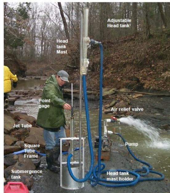
Abbildung 4-4: Beispielabbildungen für JET-Bauformen, Mini-JET (links; Al-Madhhachi et al. 2013, In-Situ-JET (rechts, Hanson & Cook 2004)
