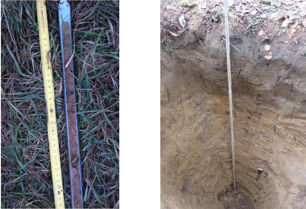
Abbildung 5-10: Beispielaufnahme Bohrstockkartierung (links) und Leitprofil (rechts)
