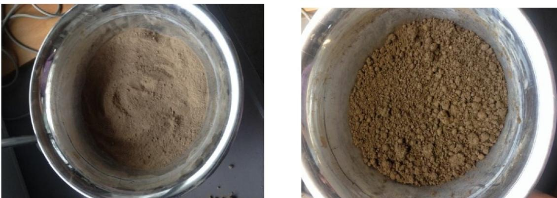
Abbildung 4-13: Getrockneter Standardboden (links) und aufbereiteter Standardboden mit Wassergehalt = 15% (rechts)
