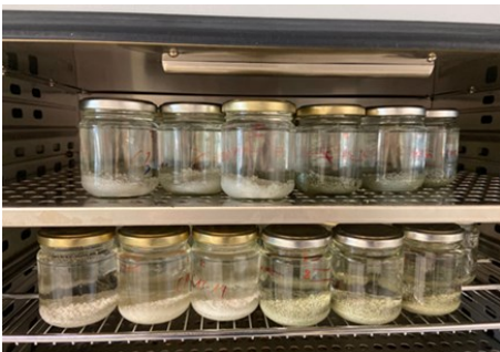
Abbildung 89: Hydrolysealterung im Wärmeschrank
