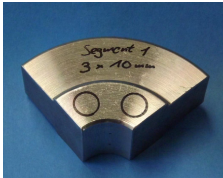
Abbildung A.1: Lage der Probenentnahme für den Werkstoff 30CrNiMo8.
