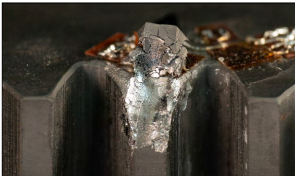
Abbildung 5.2: Darstellung des Schadens für ein kugelförmiges Fragment mit einem Durchmesser von 8 mm und einer axialen Position relativ zur Zahnbreite von 25%.
