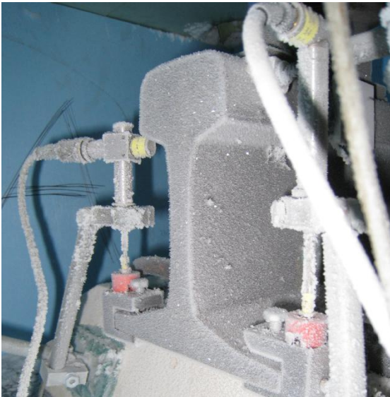
Bild. A. 2: Links: Laboruntersuchung an einzelnen Stützpunkten mit Klimabox – Eisbildung bei L/V = 0 und T = -15^{\circ}\text{C}
