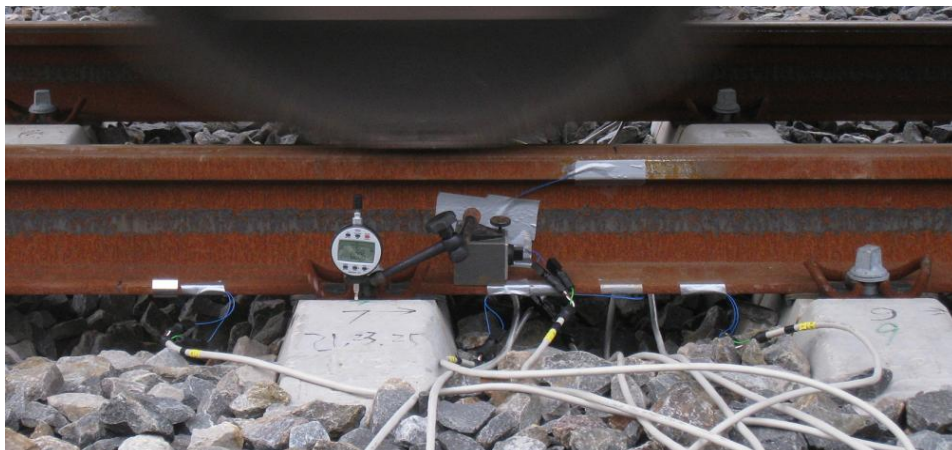
Bild 51: Testmessung gemäß Bild 50 in einer Neubaustrecke unter quasi-statischen Lasten
