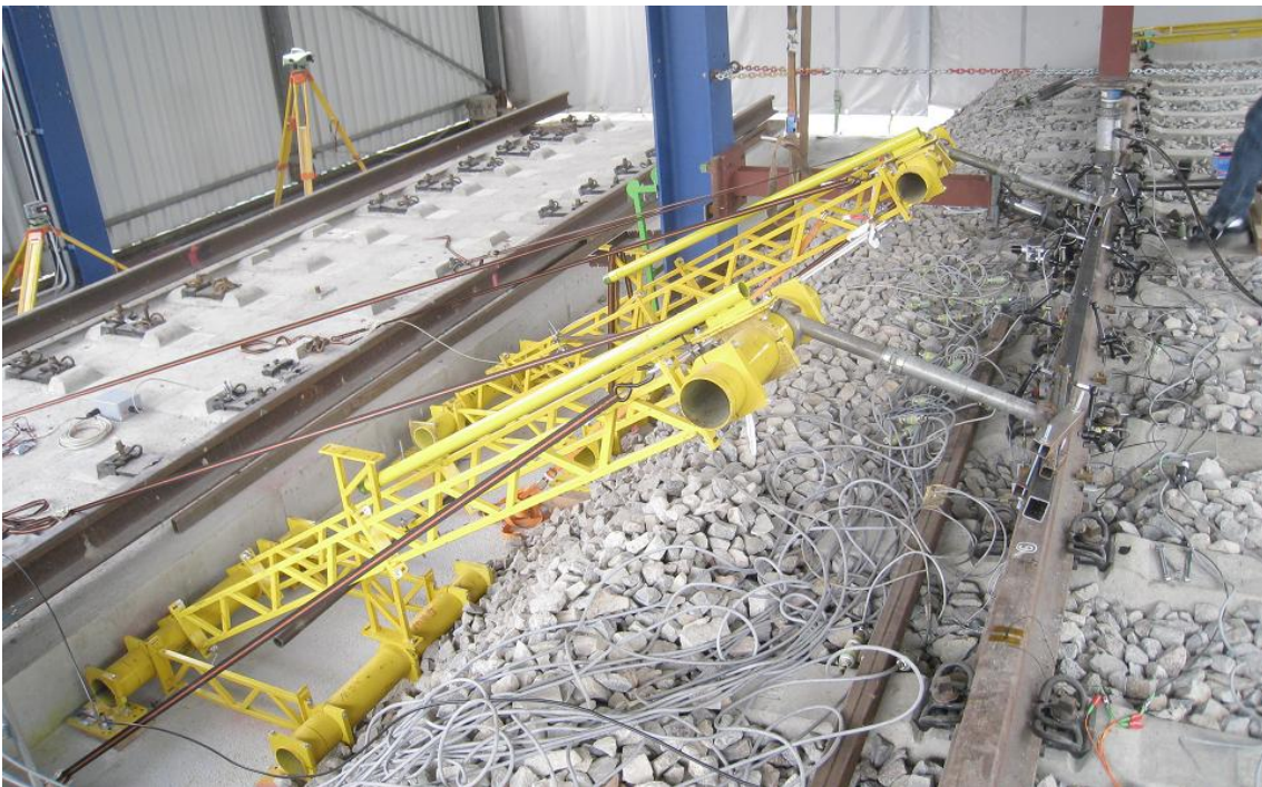
Bild. A. 4: Messung der absoluten Verformung der Schiene im Freigelände des Prüfamtes, TU München
