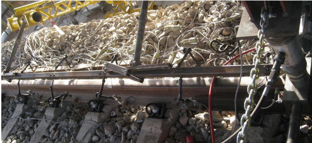
Bild 30: Kalibrierungsmessung im Labor zur Ermittlung der Beziehung zwischen Kraft und Verformung
