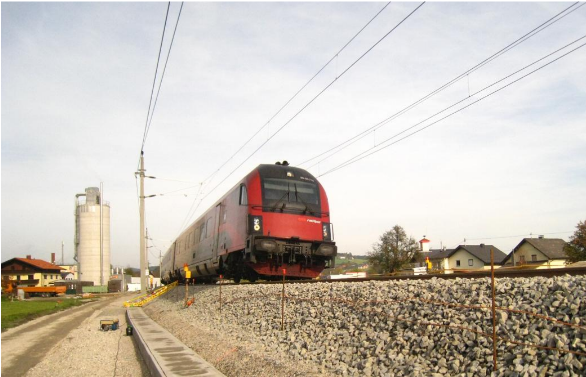
Bild. A. 5: Teststrecke Westbahn ÖBB (Redl/Zipf) - Belastungslokomotive Railjet 1116
