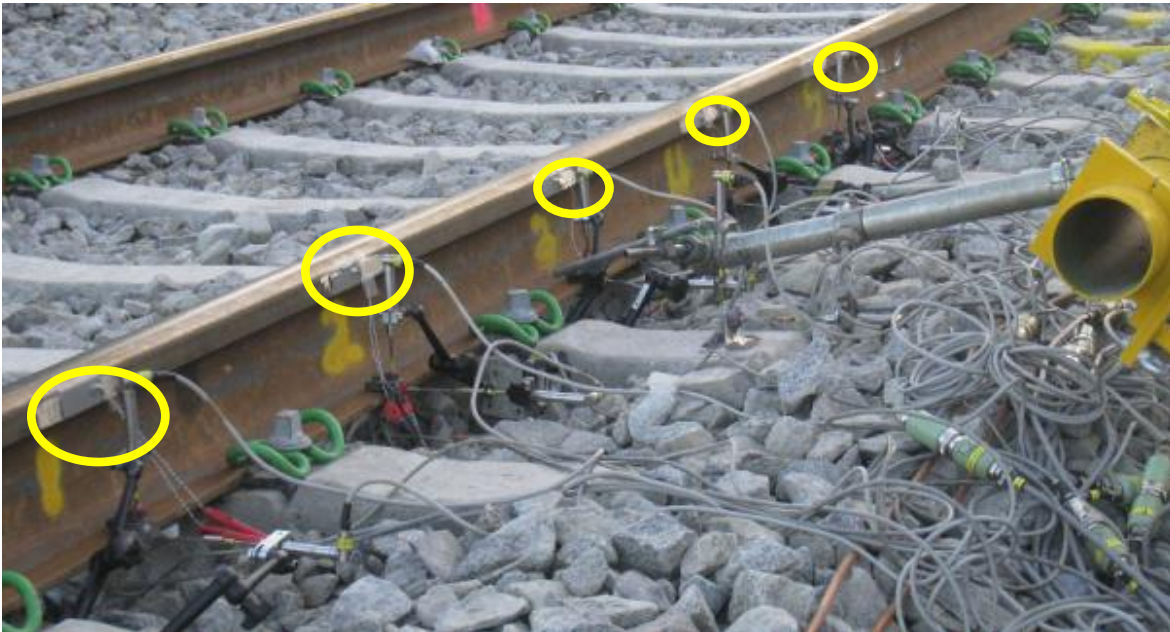
Bild. A. 7: 5 Dehnmessstreifen am Schienenkopf (DMS2)
