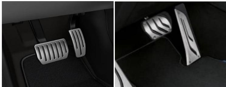
Abbildung 4: Links: Hängendes Gaspedal (Tesla, 2022). Rechts: Stehendes Gaspedal (BMW Group, 2018)
