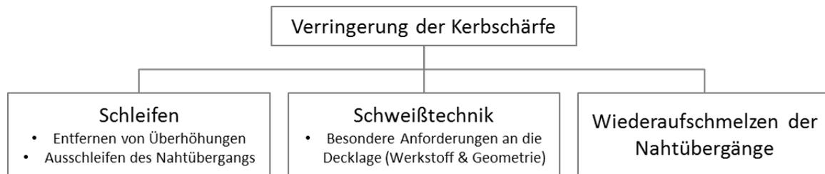
Abb. 19: Verfahren zur Verringerung der Kerbschärfe (DIN EN 1993-2)
