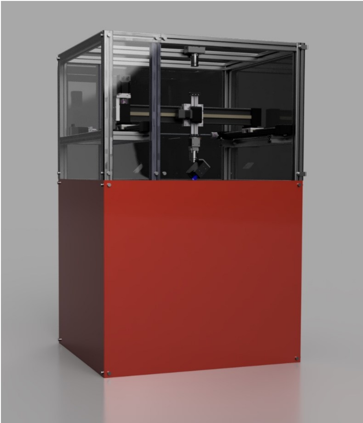
Abbildung 3.12: 3D-Render CAD-Prototyp mit Verkleidung (Tür geschlossen)
