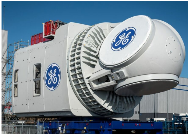
Abb. A.10.: Gondel der Windenergieanlage GE Haliade 12 MW [36] mit PMSM in Außenläuferbauweise. Von links nach rechts: Maschinenhaus, Rotorglocke mit äußeren Verstärkungsrippen, Rotorblattnabe ohne Rotorblätter. Bildquelle: Riviera Maritime Media Ltd., London, Vereinigtes Königreich, 2024.
