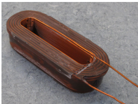
(g) Fertig gewickelte und ausgehärtete Oberschicht-Formspule
