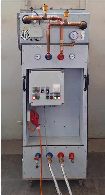
(a) Luft-Wasser-Wärmetauscher mit Kühlmittelpumpe
