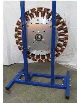
(f) Vollständig montierter Stator vor Verschaltung
