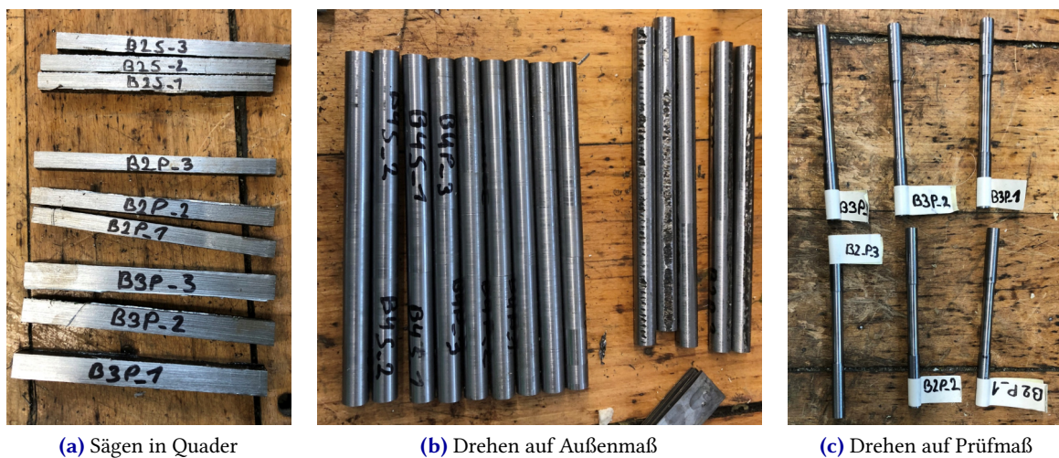
Abbildung 5.7: Herstellschritte der Zugproben
