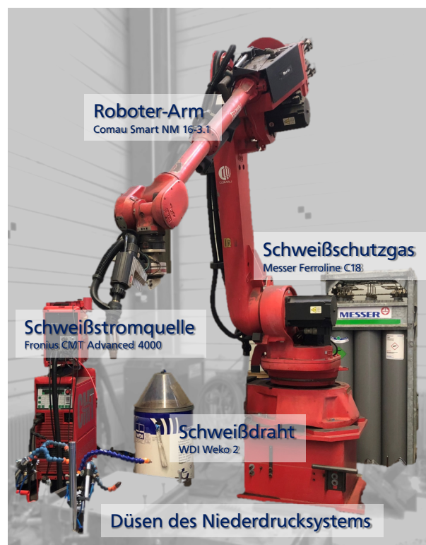
Abbildung 4.2: Aufbau des genutzten WAAM-Systems
