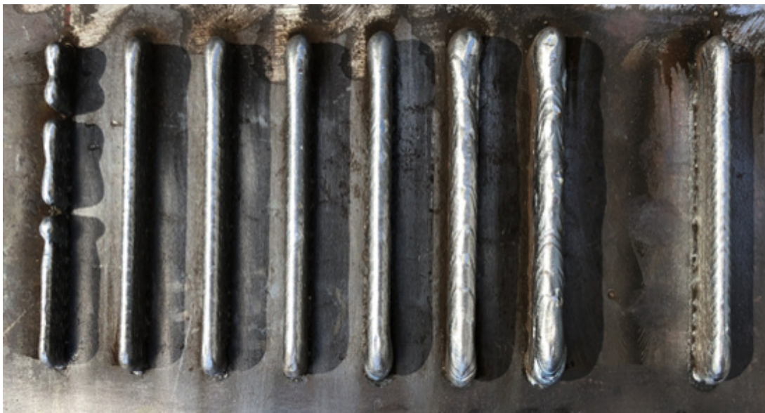
Abbildung 4.9: Schweißergebnisse der Parameterstudie
