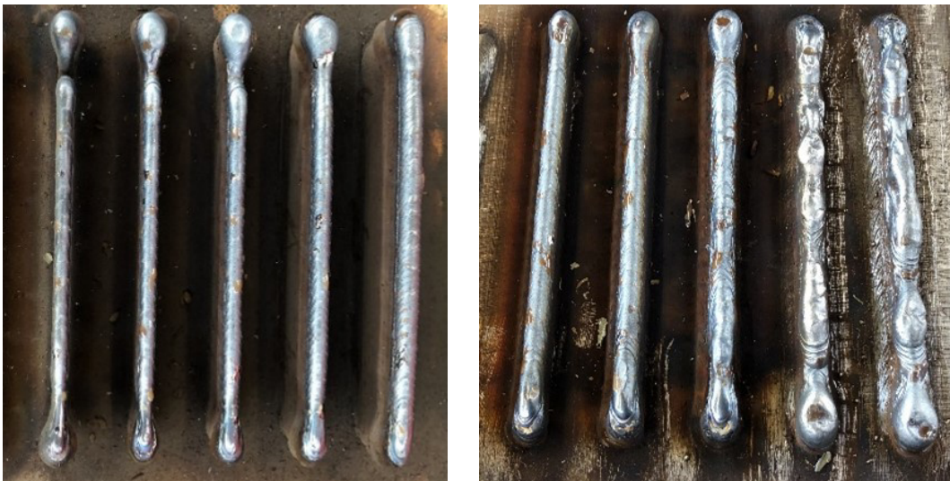
Abbildung 4.3: Untersuchungsergebnisse bei Vorgabe eines gleichen WFS/TS-Verhältnisses
