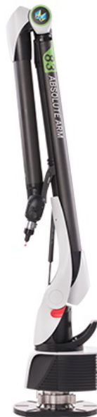
Abbildung A.7.: Hexagon Absolute Arm 8525-7
