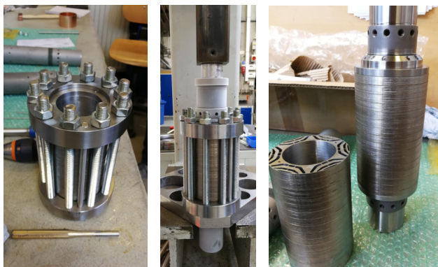
Abbildung 8.1: Aufbau des SynRM-Rotors, links: Vorspannen und Verbacken des Blechpakets, mittig: Aufschrumpfen und Nachpressen, rechts: Spindelwelle mit SynRM und Wellenmutter
