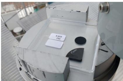
Abbildung 74: Haftoberfläche mit verschiedenen Substraten (Bor: unten rechts, C-Pad: oben rechts und Glasoberfläche: links) (Particle Vision GmbH 2020).
