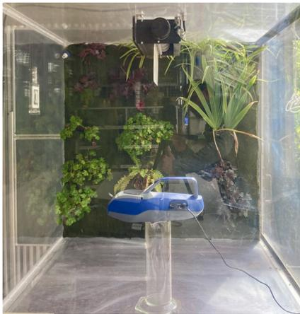
Abbildung 72: Messkammer mit aufgestelltem Messgerät und eingesetztem Vegetationselement.
