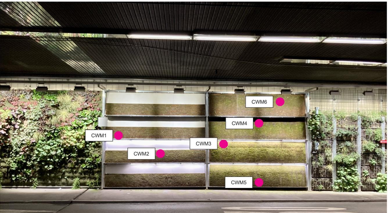
Abbildung 58: Anordnung der Messpunkte zur Wachstumsmessung von Moosen nach der Cranked-Wires-Methode.
