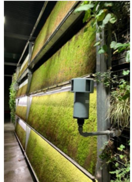
Abbildung 28: Eingesetzter Sigma-2 Passivsammler im Citytunnel Darmstadt.
