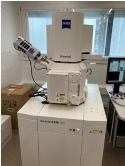
Abbildung 32: Verwendung eines Zeiss GeminiSEM 300 zur morpho-chemischen Partikelanalyse.
