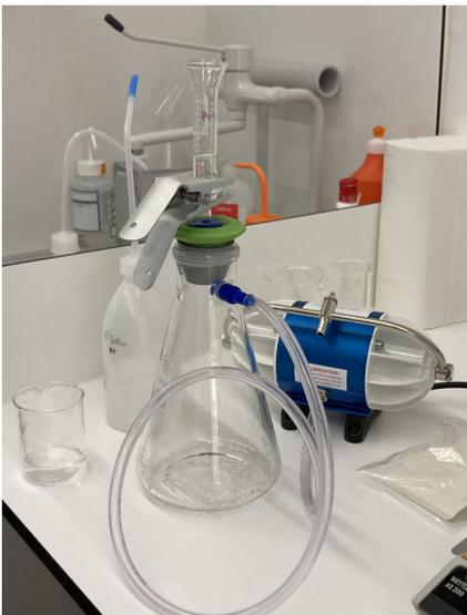
Abbildung 76: Filtration der Flüssigkeit aus dem Ultraschallreinigungsbecken.
