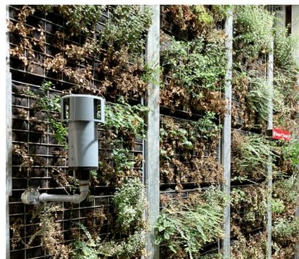
Abbildung 37: Installierter Sigma-2-Passivsammler im Citytunnel Darmstadt.
