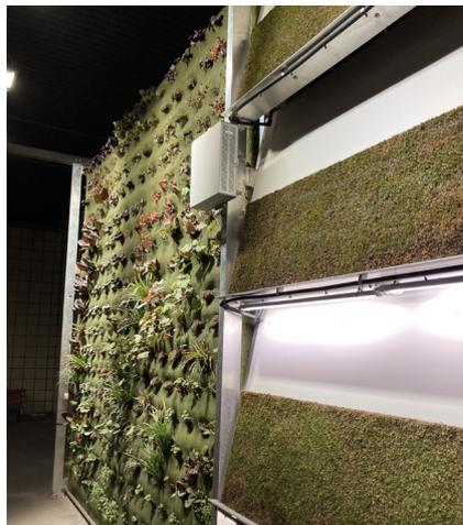
Abbildung 54: Montiertes Messgerät HDD169 vor der Begrünung zwischen Bereich 1 und Bereich 2.
