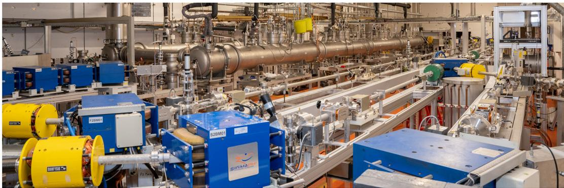
Abbildung 4.1: Fotografie des S-DALINAC: Im Vordergrund die drei Rezirkulationen und im Hintergrund die Kryostatmodule des Hauptbeschleunigers. Im hinteren rechten Bereich ist der COBRA Aufbau zu sehen. Gelb und grün sind Quadrupolmagneten, blau sind die Dipolmagnete.
