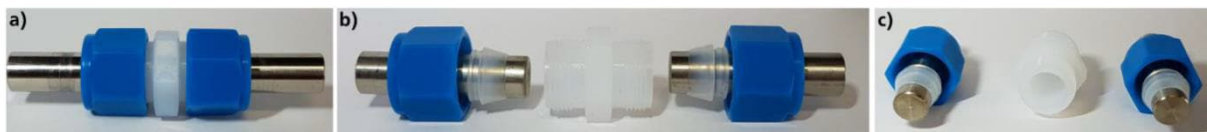
Abbildung 9: Verwendete Swagelok ® -Zelle zur elektrochemischen Charakterisierung binderfreier Elektroden auf Basis von CNH-Materialien
