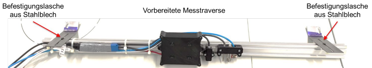
Abbildung 31: Angepasste Messtraverse mit Sensoren und neuen Befestigungslaschen zur Montage in der Druckmaschine
