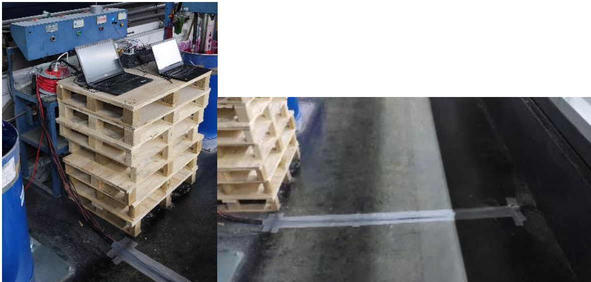
Abbildung 42: Aufbau des Messstandes und Verlegung der Kabel zur Abdeckung der Druckmaschine
