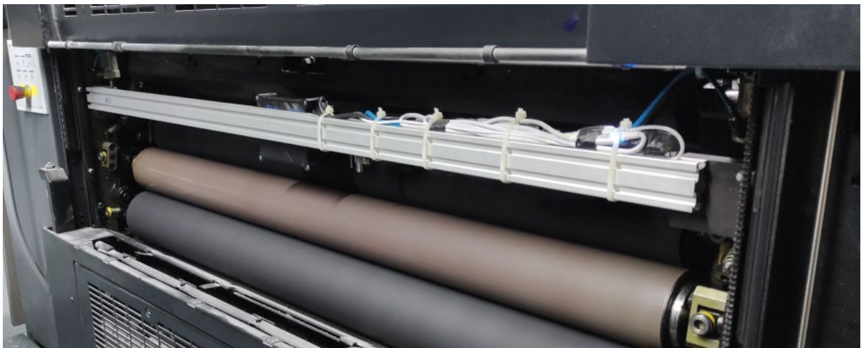
Abbildung 39: In der Druckmaschine eingebaute Messtraverse mit Sensorbox, Sensorhalterungen und entsprechenden Sensoren (vor der versuchsbegleitenden Produktion)
