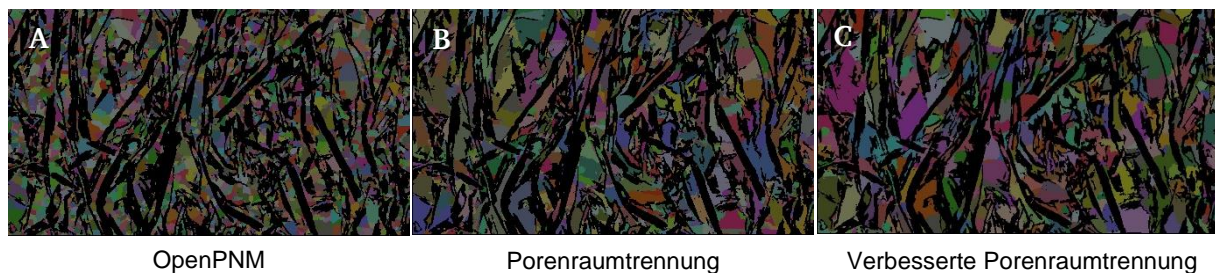
Abbildung 5.4: Vergleich der Porenraumunterteilung von A OpenPNM, B dem im Kapitel beschriebenen Algorithmus zur Porenraumtrennung und C der verbesserten Porenunterteilung des Algorithmus nach drei Iterationsschleifen. 200 µm
