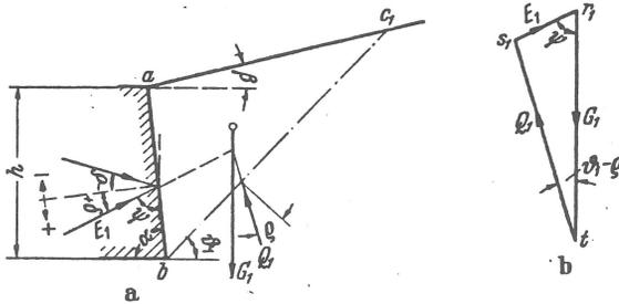
Abb. 20 a—d. a u. b Darstellung der Annahmen der COULOMBSchen Erddrucktheorie; —
