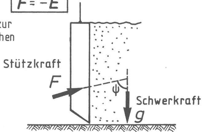
**Bild 3** Versuch mit erzwungener Richtung  $\psi$  des Erddrucks
