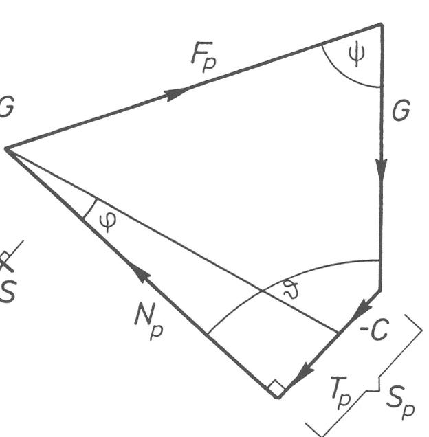
**Bild 4a** Aktive Keilstützkraft  $F_a$  des Keils  $\vartheta$  bei Ausnutzung der Scherfestigkeit
