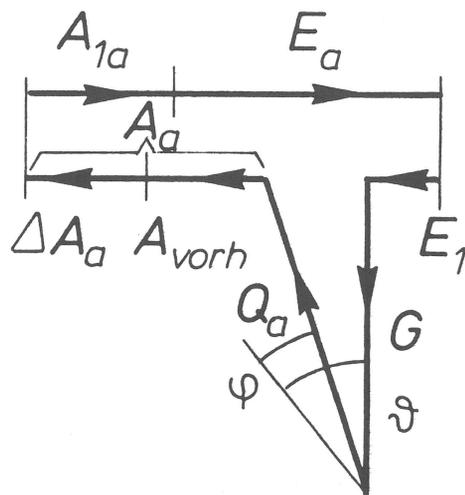
Bild 15 Aktive Keilankerkraft  $A_a$  des Keils  $\vartheta$  bei vollständig mobilisierter Reibung  $\varphi$  im Schnitt  $\vartheta$
