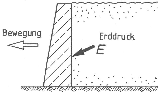
Bild 1 Erddruck  $E$  auf eine Schwergewichtsmauer
