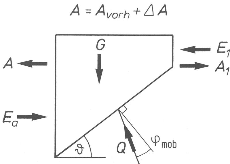
**Bild 13** Freigeschnittener Bodenkeil  $\vartheta$  und die an ihm angreifenden Kräfte
