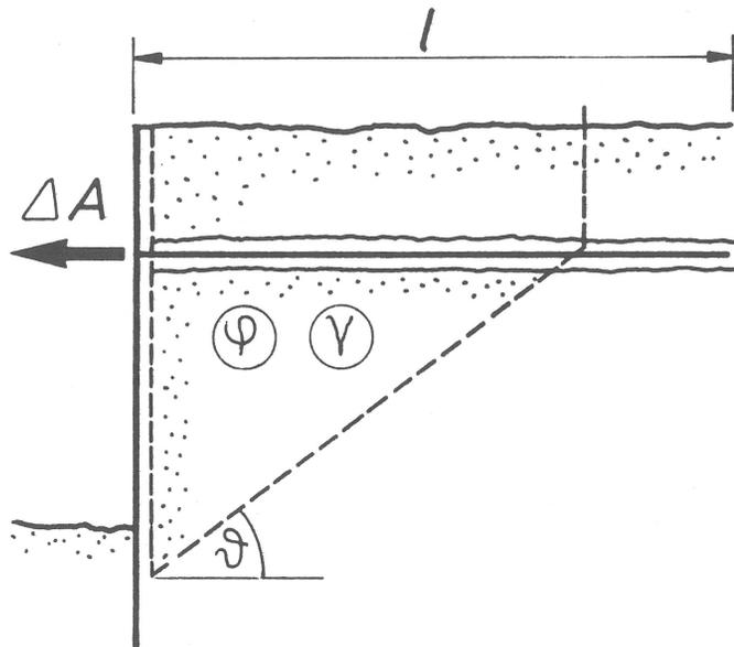
**Bild 12** Schnitt nach Art der KRANZschen tiefen Gleitfuge unter dem Winkel  $\vartheta$  durch Boden hinter der mit Verpeßpfählen verankerten Wand
