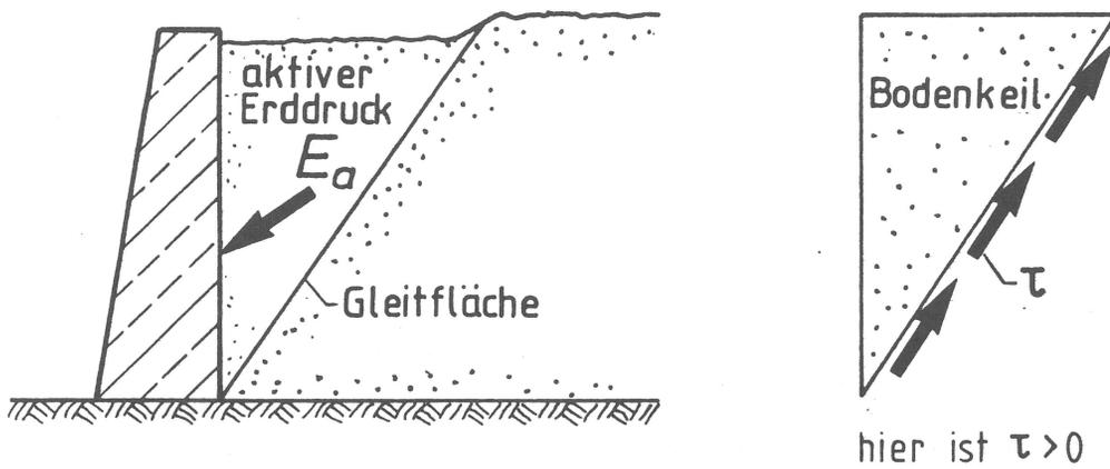
Bild 2 Aktiver Erddruck  $E_a$  nach Ausbildung einer Gleitfläche
