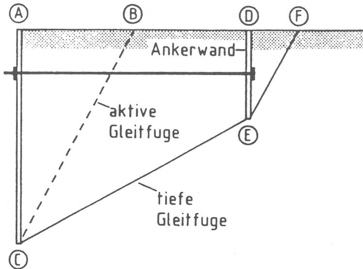
Bild 10 Tiefe Gleitfuge des Systems der verankerten Stützwand nach KRANZ
