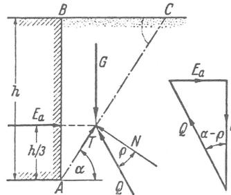
Abb. 8.3. Bestimmung des Erddruckes nach COULOMB
