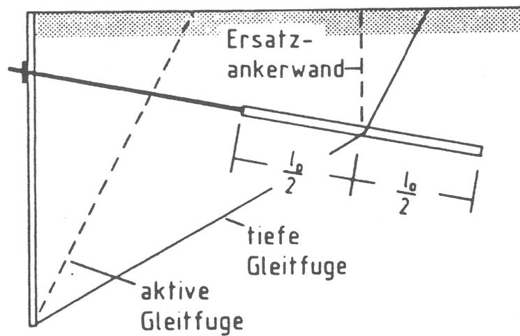
Bild 11 tiefe Gleitfuge bei Verankerung durch Verpreßanker nach EAU/EAB
