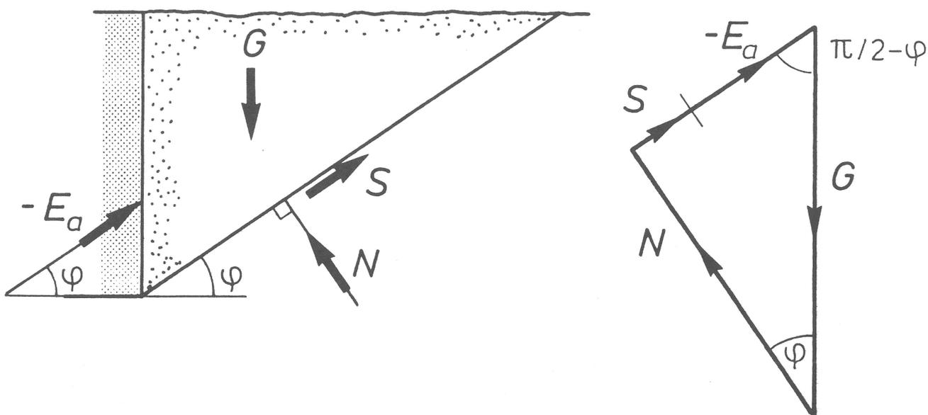
Bild 6 Stand der Theorie des aktiven Erddrucks in rolligen Boden zur Zeit COULOMBS
