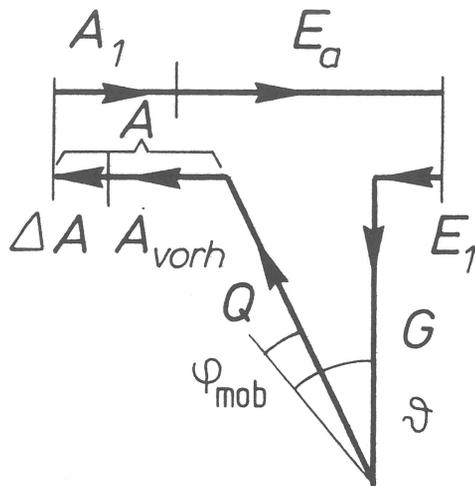
Bild 14 Schnittkräfte im Schnitt  $\vartheta$  zufolge der variierten Ankerkraft  $A$
