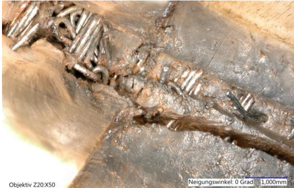
(a) Foto eines defekten Zahnriemens, bei dem sich die gebrochenen Zugträgerdrähte bewegt und aufgestaut haben.
