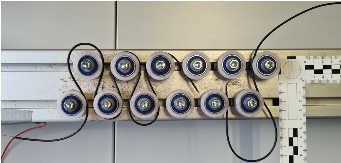
Abbildung 2.42: Ausschnitt des Prüfstands zur beschleunigten Alterung von Zugträgern. Zu sehen ist ein eingespannter Zugträger zwischen den elektrisch isolierten Umlenkrollen.
