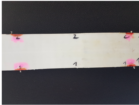
(a) Rückseite des Zahnriemens mit austretenden Zugträgern zum Vermessen.
