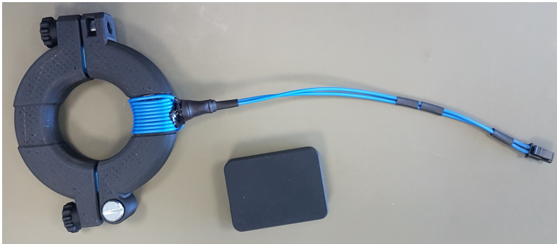
(a) Aufklappbarer Schwingkreis zum Induzieren der elektrischen Energie, zusammen mit der Wechselspannungserzeugung.
