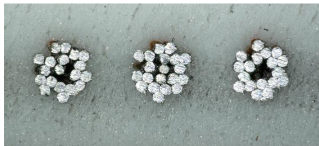
Abbildung 2.3: Querschnitt eines gealterten Zahnriemens.
