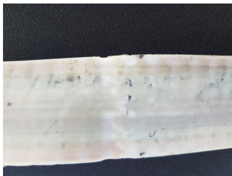
(a) Rückseite des ausgefallenen Zahnriemens.
