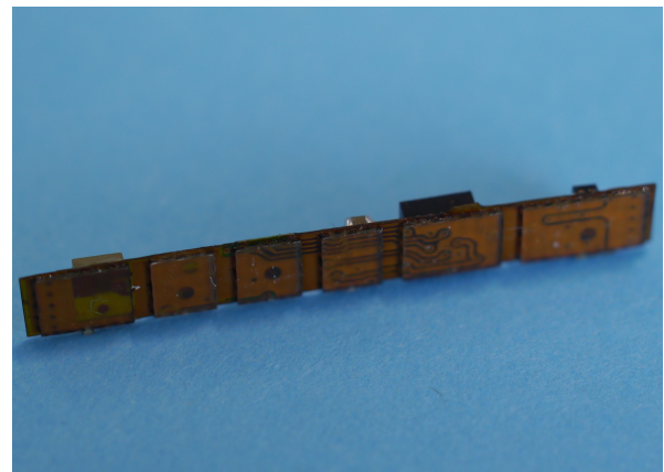
(b) Sensorik von unten, sodass die Versteifungen erkennbar sind.
