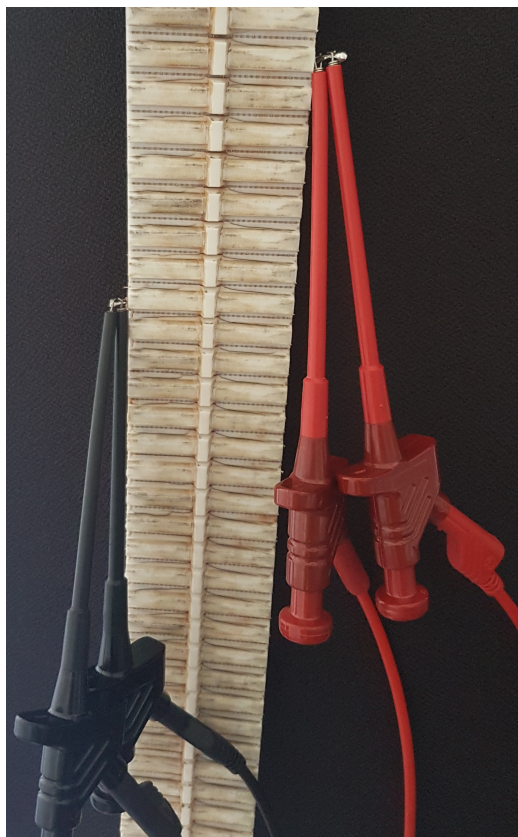
(a) Vierleiter Widerstandsmessung am Zahnriemen.
