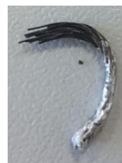
(b) Gebrochenes Zugträgerende.
