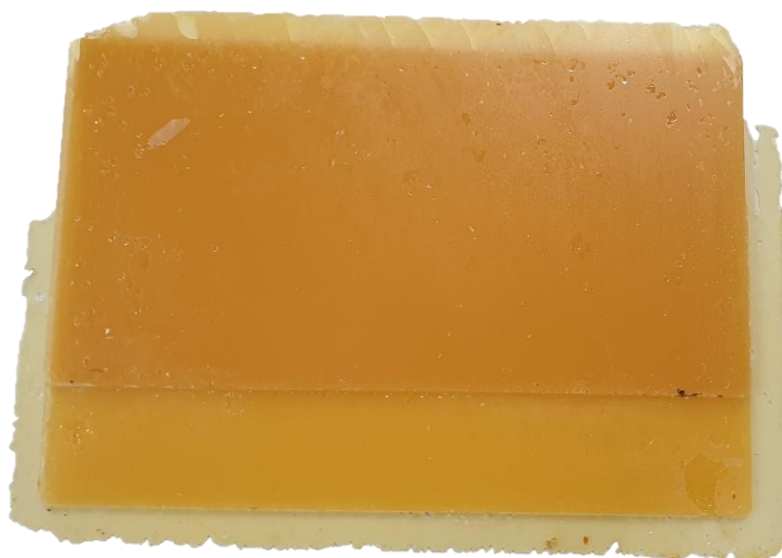
Abbildung 60: Gehärtete Platte aus RTM 6 und Poly-VSi18a. Im oberen Bereich ist eine helle Schicht abgesetzt.
