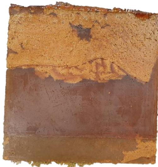
Abbildung 32: Erhaltene Platte mit SCP-MeSil 9a in RTM 6 nach der Härtung bei 180 °C.
