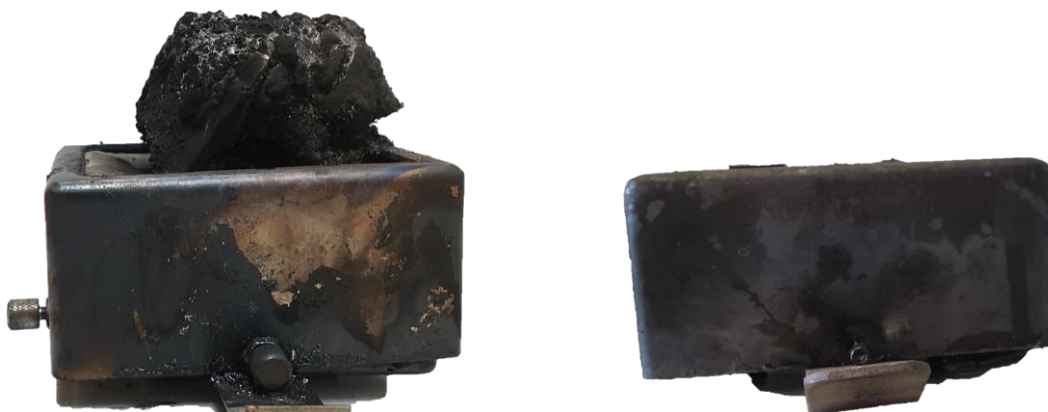
Abbildung 46: Links: in RTM 6 eingearbeitete Probe von SCP-VSil 14a nach der Bestrahlung im Cone Kalorimeter (35 kW m -2 , 500 s). Aufgrund der starken Intumeszenz berührte die Probe beim Entnehmen die Heizwendeln des Cone Kalorimeters und die obersten Schichten sind abgetragen worden. Rechts: Referenzprobe von reinem RTM 6 0a .
