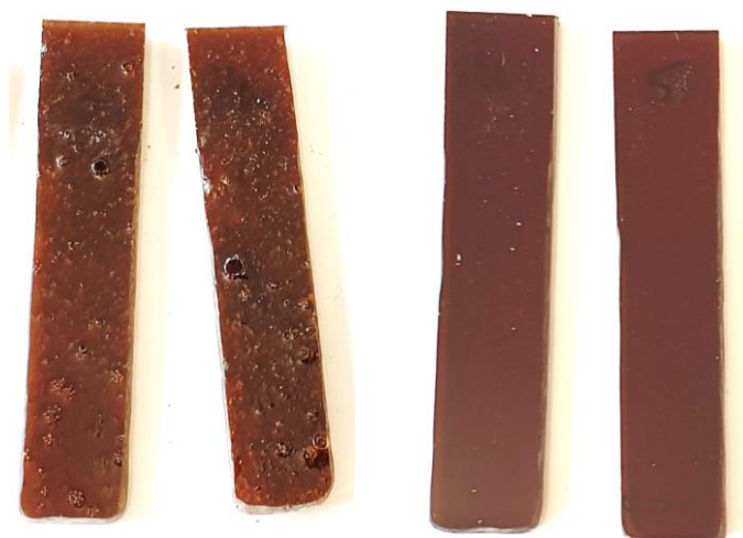
Abbildung 43: Vergleich zwischen gehärteten Proben von Spiro-VSil 2 16a (links) und DOPO-VSil 15a (rechts) in RTM 6. Während der Prozessierung entstehende Gase verursachen eine poröse Oberfläche (links).
