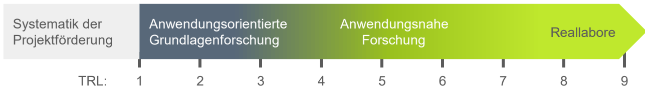
Abbildung 1-1: Technology-Readiness-Level (TRL) im Kontext der Projektförderung im 7. Energieforschungsprogramm. Bild in Anlehnung an [2].
