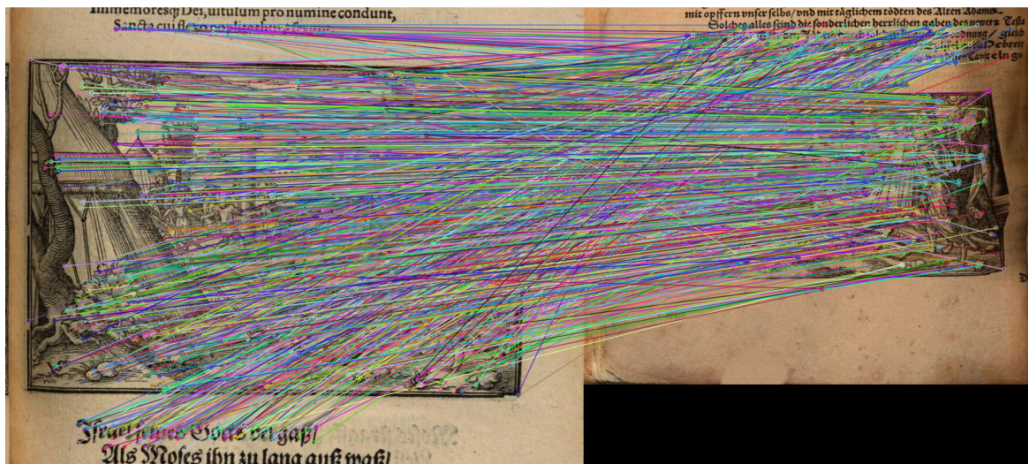
Abbildung 3.20.: Alle Treffer eines Matching-Algorithmus zwischen zwei Buchseiten
