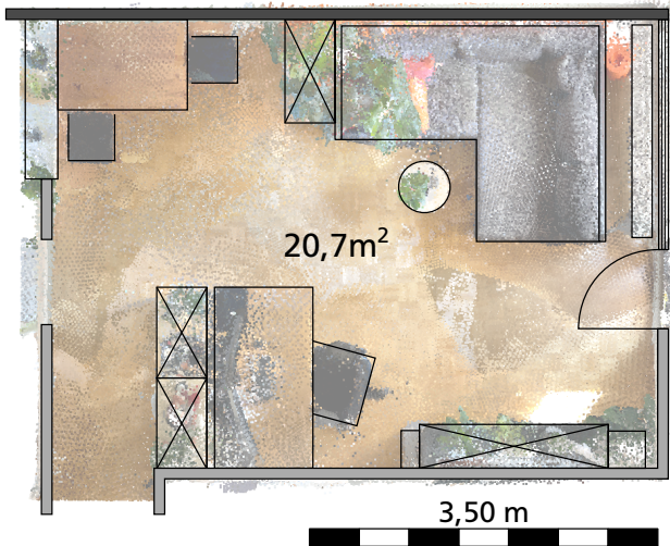
Abbildung 6.10: Grundrissdarstellung mit RGB-texturierter Punktwolke eines Wohnzimmers
