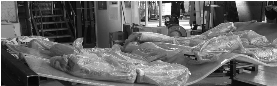
Abb. 5.28 Großversuch eines zerstörten, herabgefallenen Sinusbogens aus Glas [F2]
