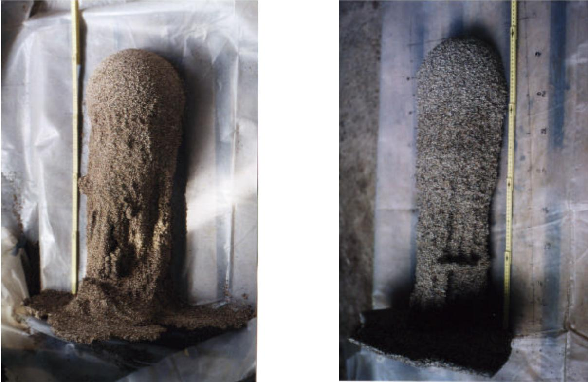
Abb. 7.17: Weitere Beispiele für Injektionskörper mit „Finger“-Bildung
