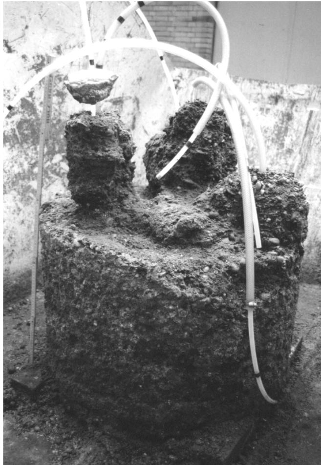
*Abb. 7.30: Freipräparierter Injektionskörper aus Laborversuch mit 3 Eingabestellen*
