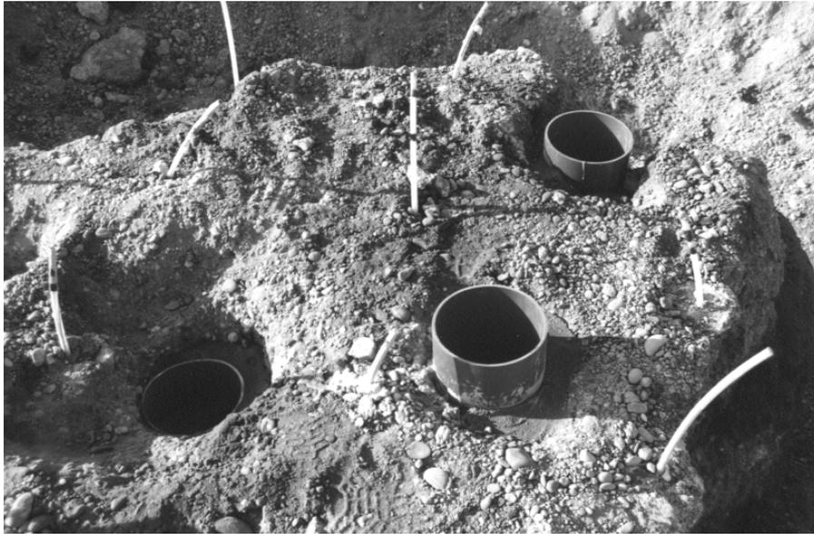
Abb. 7.42: Versuche zur Bestimmung der Durchlässigkeit des im Feldversuch hergestellten dränfähigen Injektionskörpers
