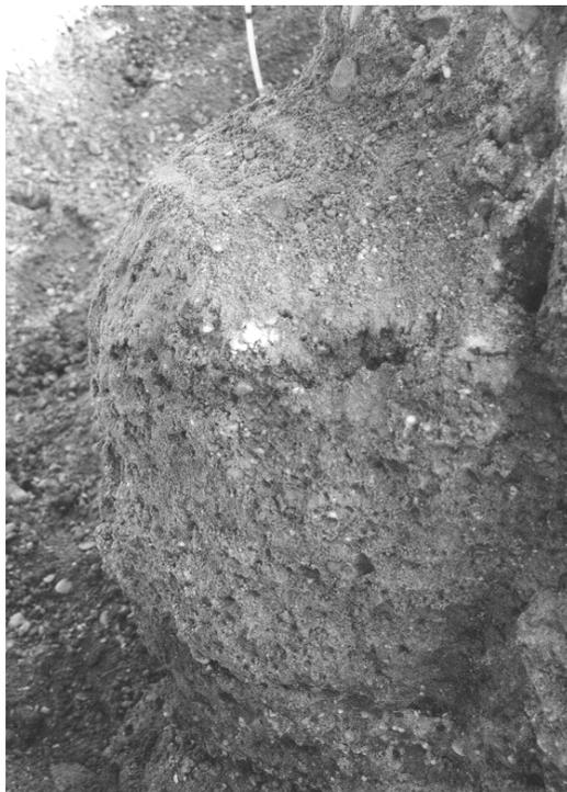
*Abb. 7.40: Im Feldversuch hergestellter dränfähiger Injektionskörper*
