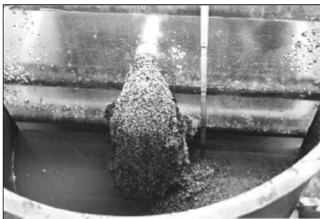
Abb. 6.15: Form eines stabilisierten Bodenkörpers bei zopfförmigem Abfließen des Injektionsmediums infolge eines niedrigen Q/k_{WG} -Verhältnisses (Versuch im Injektionshalbzylinder; s. Kap. 7.1.2.1)
