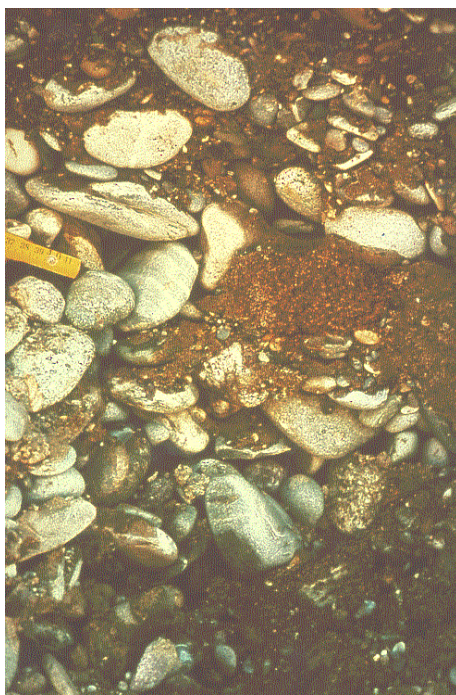
Abb. 4.4: Junge, quartäre Ablagerungen: Beispiele für extrem erosions- und suffosionsanfällige Lockergesteinsablagerungen
