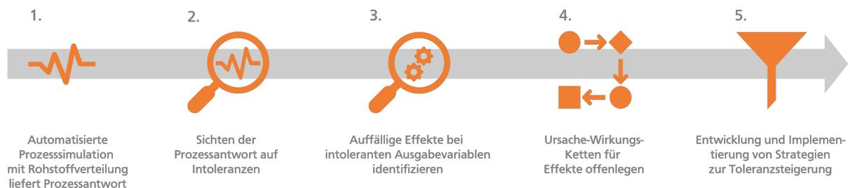
Abbildung 33: Ablaufdarstellung der in dieser Arbeit entwickelten Prozesstoleranzanalyse mit Datengenerierung (Schritt 1) und Datenanalyse (Schritte 2 bis 4).
