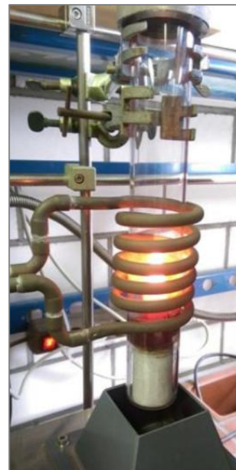
Abbildung 1: Schematische Darstellung des verwendeten Hochfrequenz-Induktionsofens (links) und Detailansicht des Reaktors (rechts).
