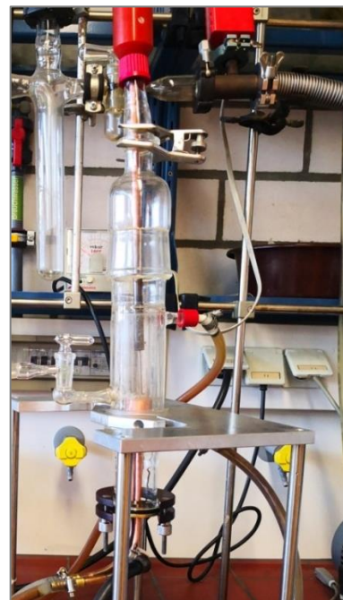
Abbildung 2: Schematischer Aufbau des Lichtbogenofens (links) und verwendeter Lichtbogenofen (rechts).
