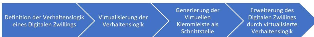
Abbildung 4.1: Konzeptionellen Schritte bei der Integration der Verhaltenslogik in den Digitalen Zwilling mittels einer Virtuellen Klemmleiste
