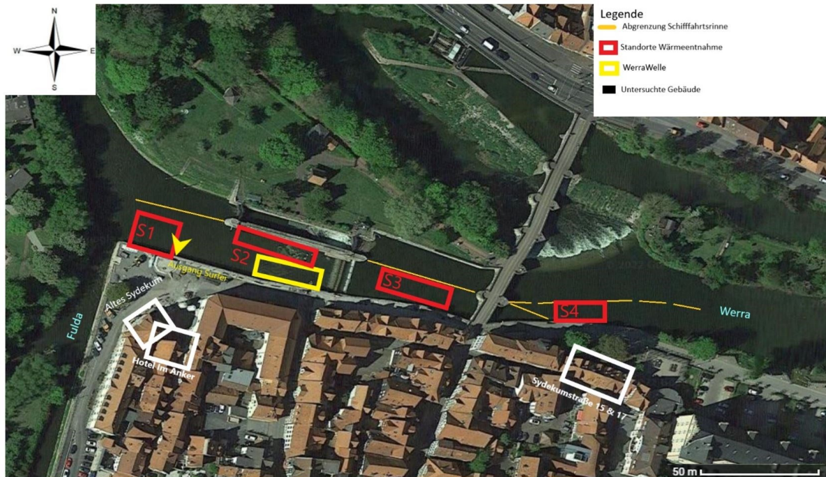
Abbildung 5-1: Potenzielle Standorte für die Entnahme der Werra-Wärme unmittelbar am Nadelwehr (eigene Darstellung auf Grundlage eines Luftbilds vom Bundesamt für Kartographie und Geodäsie (BKG))
