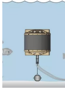
Abbildung 5-7: Beispiel für die Montage eines Wärmeübertragers mit Verankerungsgewicht (Frank GmbH, 2022)
