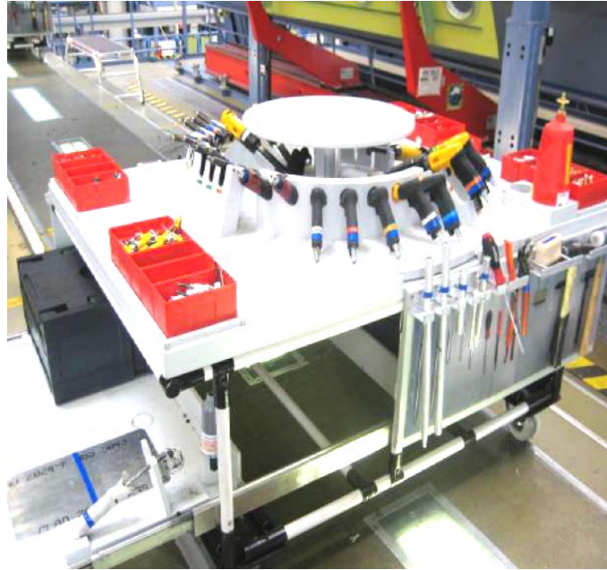
Abbildung 9: Geordnete Darbietung der notwendigen Fügwerkzeuge (Bild: Bokranz, Landau 2012)
