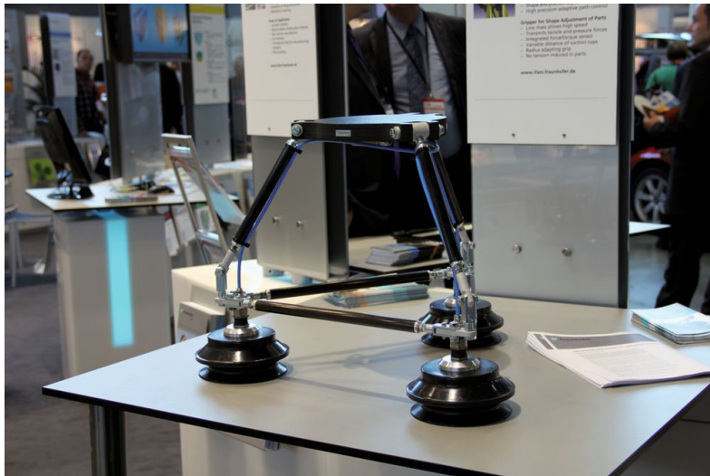
Abbildung 10: Roboter mit Sauggreifer können geometrisch unterschiedliche große Bauteile positionieren (Bild: Kraus/MM Maschinenmarkt 2011)
