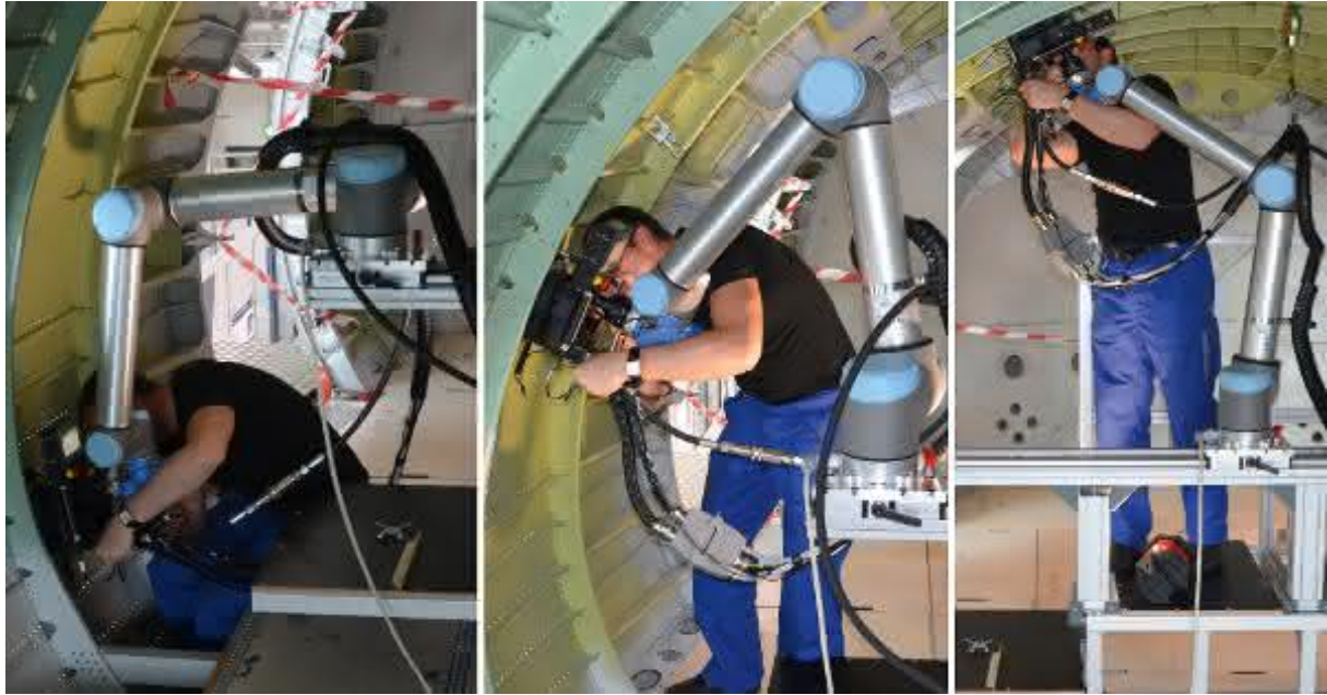
Abbildung 11: Montage einer Stringer-Kupplung mithilfe eines kollaborativen Roboters im Flugzeugrumpf (Bild: Tox Pressotechnik/ Industrial Production)
