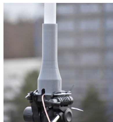
Abbildung 8.8: Darstellung des Entwurfs der Antennenhalterung (links) und Nahaufnahme der 3D-gedruckten Antennenhalterung (rechts). (Eigene Aufnahmen)
