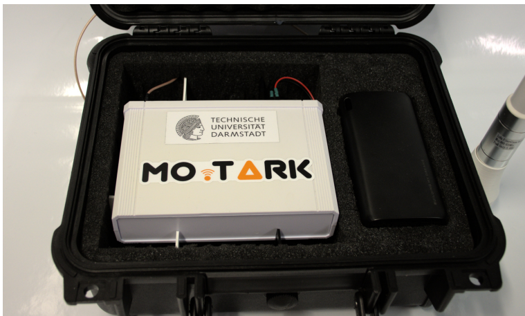
Abbildung 7.12: Fotoaufnahme der Basisstation. In dem Schutzkoffer sind das Gateway sowie die Batterie untergebracht. Die Antenne ist außen angebracht. (Eigene Aufnahmen)
