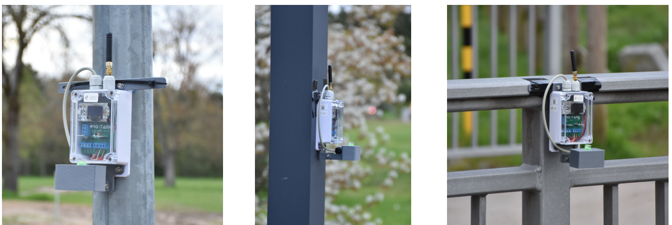
Abbildung 7.15: Fotoaufnahme eines Sensorkits befestigt an verschiedenen Laternen (links, mitte) sowie an einem Brückengeländer (rechts). Angeschlossen auf diesem Foto ist ein Ultraschallsensor. (Eigene Aufnahmen)
