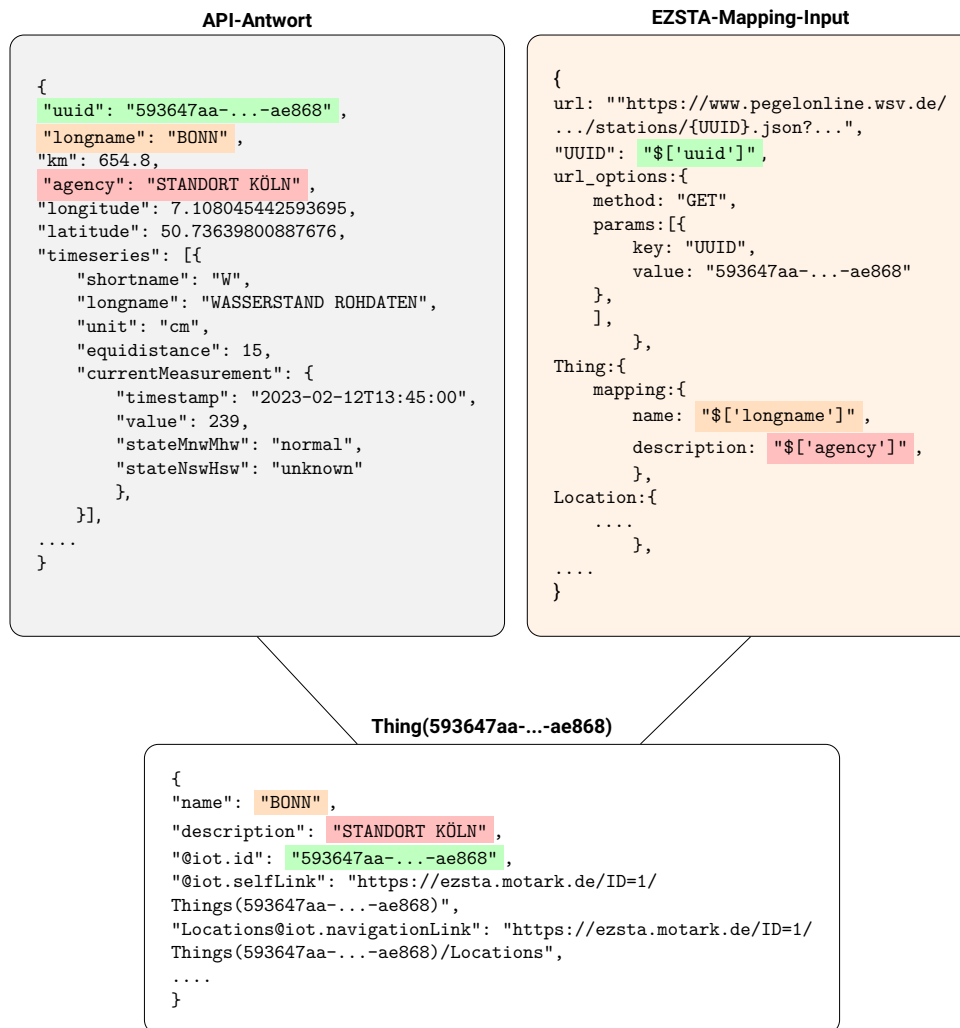
Abbildung 6.4: Auszugsweise Darstellung der API-Antwort (links), des Mapping-Inputs (rechts) sowie der durch EZSTA erzeugten Thing-Klasse für die Pegelonline-API für eine Pegelstation. (Eigene Darstellung)
