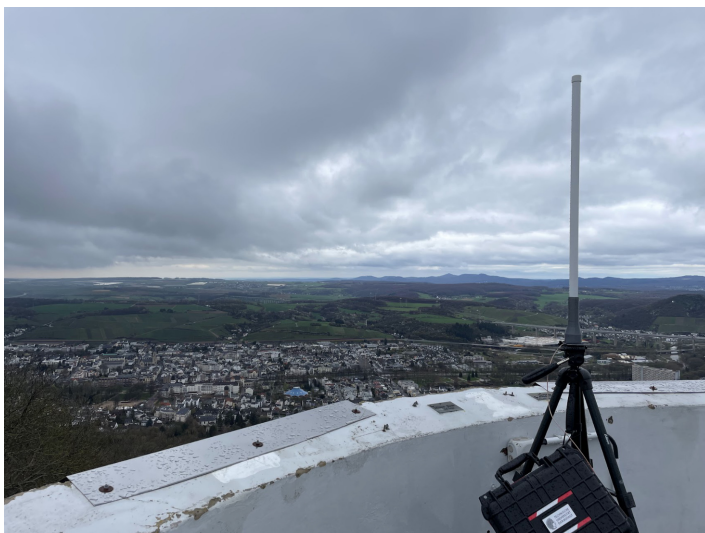
Abbildung 8.17: Fotoaufnahme der Basisstation (links) montiert auf dem Aussichtsturm (rechts) am Aussichtspunkt Neuenahrer Berg. (Eigene Aufnahmen)
