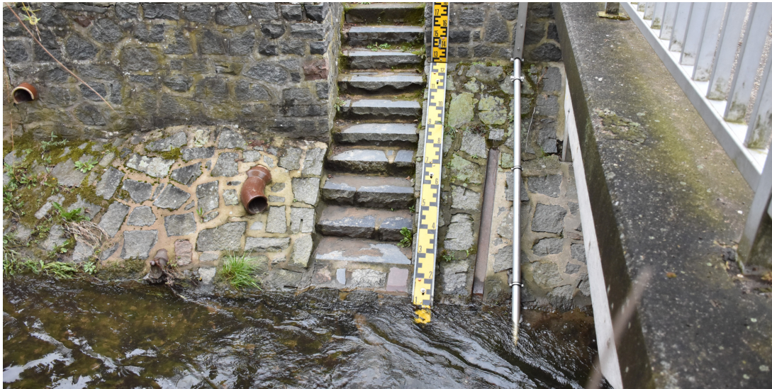
Abbildung 2.9: Fotoaufnahme eines Lattenpegels. Aufgenommen im Fischbachtal (Odenwald). (Eigene Aufnahme)
