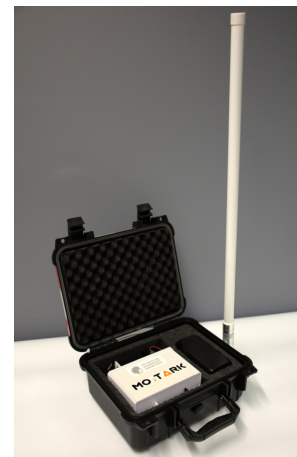
Abbildung 7.12: Fotoaufnahme der Basisstation. In dem Schutzkoffer sind das Gateway sowie die Batterie untergebracht. Die Antenne ist außen angebracht. (Eigene Aufnahmen)
