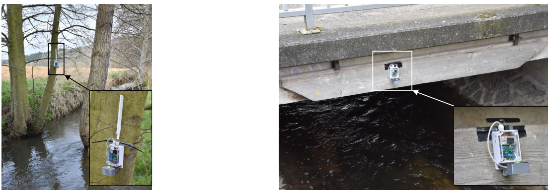
Abbildung 8.16: Fotoaufnahmen der befestigten Sensoren an einem Baum (links) und einer Brücke (rechts). (Eigene Aufnahmen)
