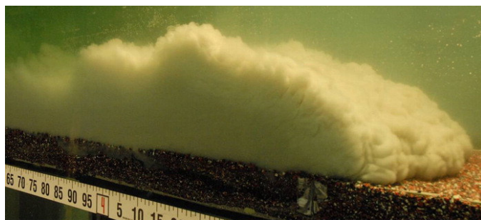
Abbildung 10: In Laborversuchen erzeugter Dichtestrom (Sequeiros et al. 2010)
